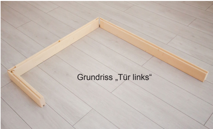
Abb. 1: Auflegen der drei Bodenrahmen-Elemente
