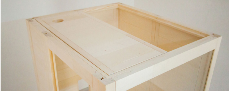
Abb. 14: Einlegen Dachelemente vorne
